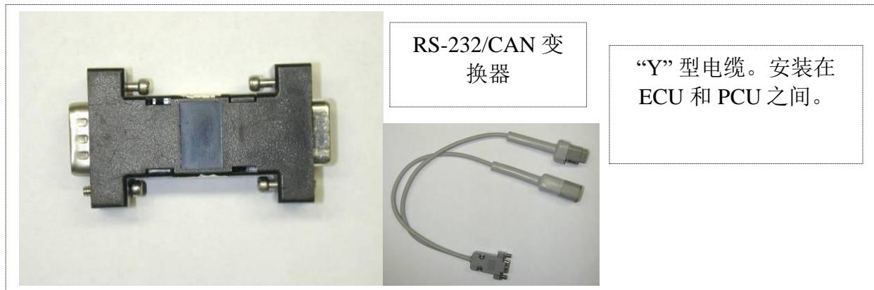
Figure 21: RS-232/CAN 和 Y型电缆
