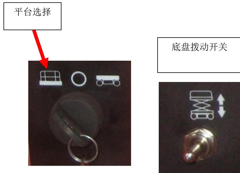
**Figure 27:** 开关位置和没有负载的标定程序
